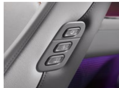
Функція комфортного доступу водія до налаштувань сидіння переднього пасажиря "Walk-in device"
