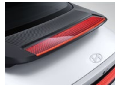
Стрічка сигналу стоп "Parametric Pixel" на задньому спойлері.
