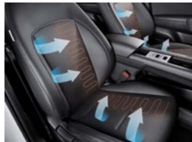
Вентиляція та підігрів передніх сидінь
