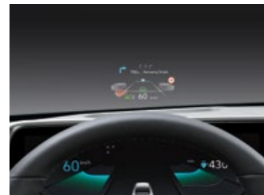
Проекція інформації на лобовому склі з функцією доповненої реальності
